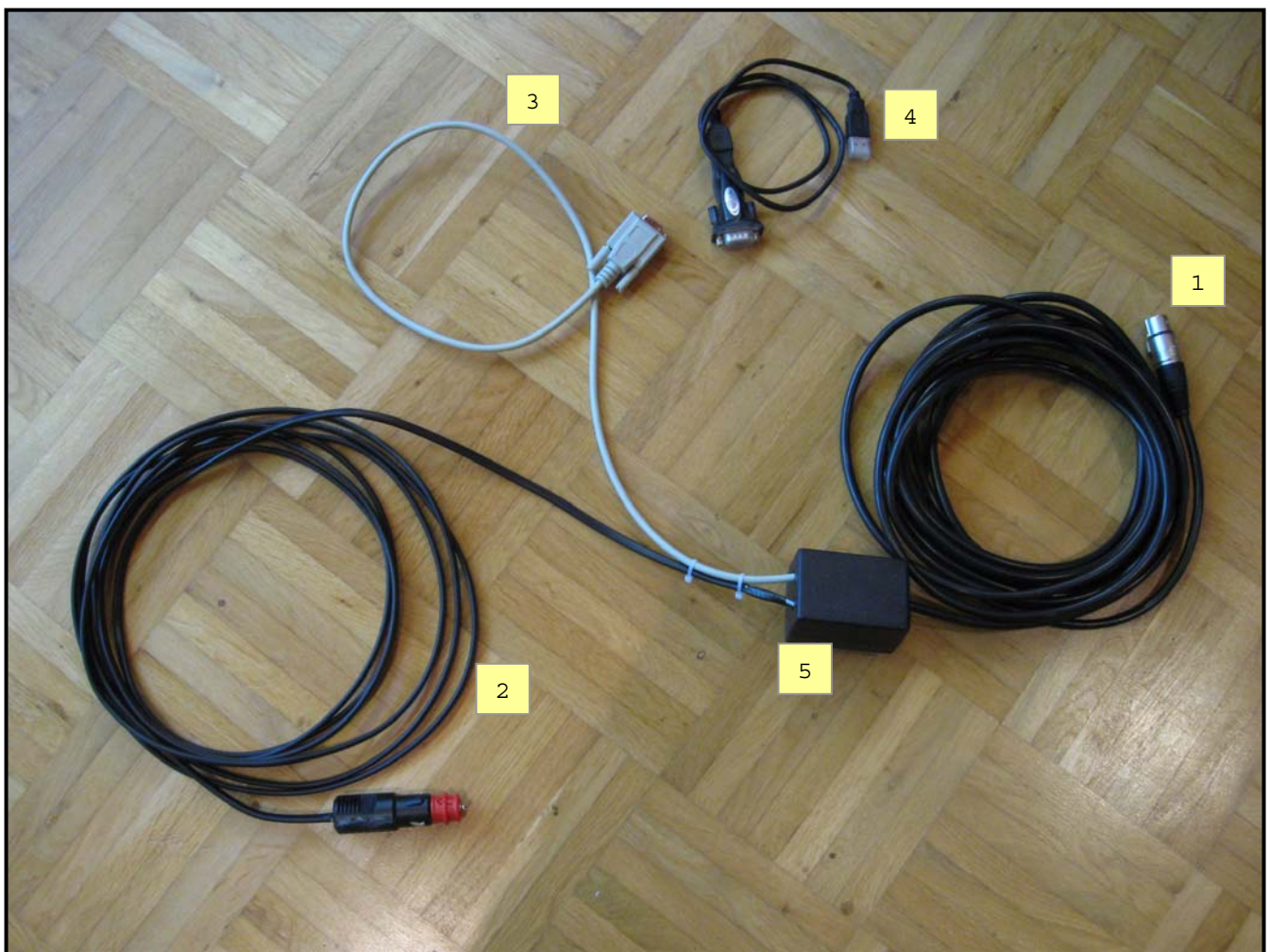
Abb. 11.01 / Foto Steuerleitung nach Schaltplan 8.01 ohne Umschaltung für Zwischenzeit
