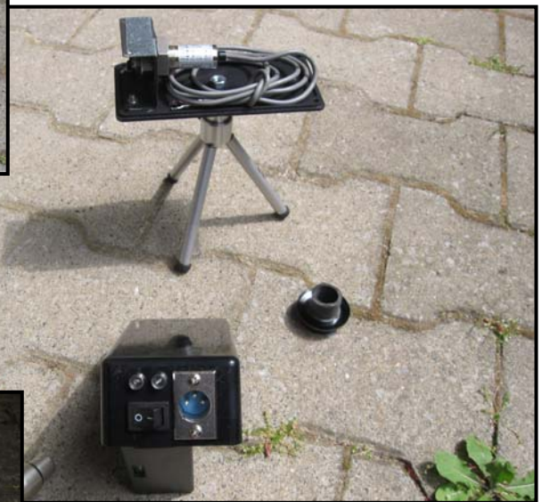
Abb. 7.02 / Infrarot-Reflektionslichtschanke (Gehäuserückseite und Befestigungswinkel für Infrarotsensor)
